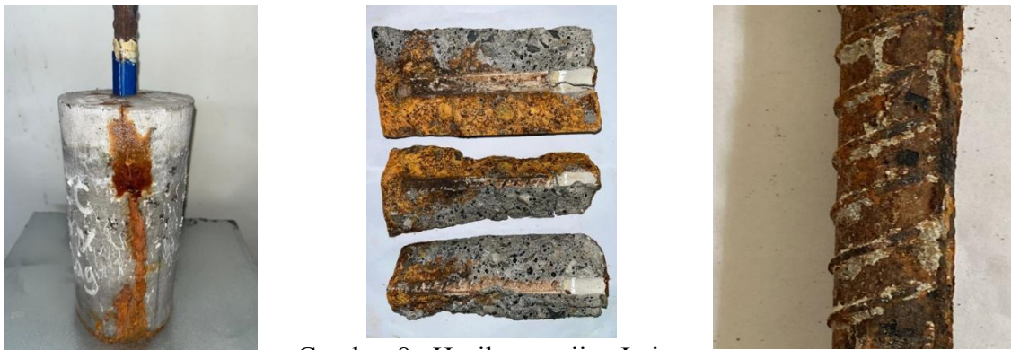
Gambar 8. Hasil pengujian Laju Korosi Tulangan SN 50%.
