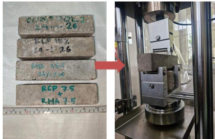
Gambar 1. Setup pengujian perilaku lentur mortar.
