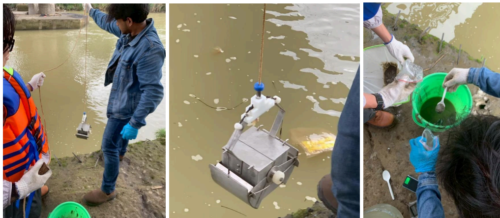
Gambar 2. Pengambilan Sampel dengan Ekman Grab .
