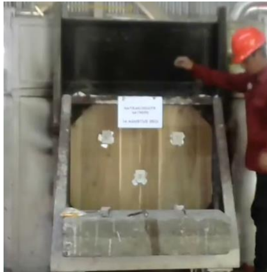
Gambar 11. Letak termokopel pada benda uji
