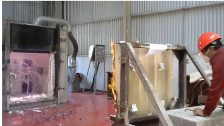
Gambar 12. Benda uji sesaat setelah keluar dari tungku pembakaran
