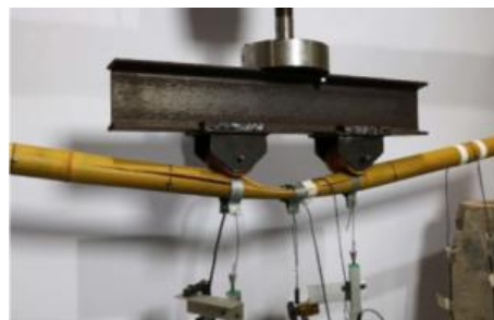
Gambar 31 Local Failure pada bambu oleh Musthaffa et al (2024)
