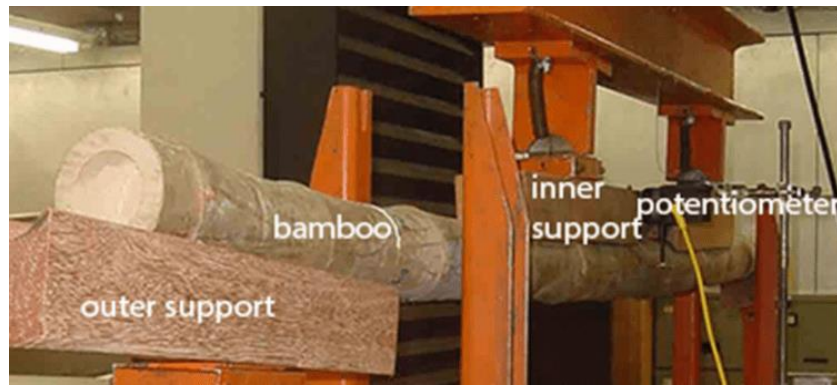
Gambar 6 Konfigurasi Pengujian Lentur oleh Sá Ribeiro et al (2017)
