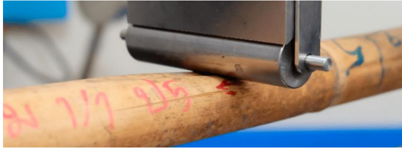
Gambar 29 Longitudinal Splitting pada bambu oleh Chaowana et al (2021)
