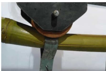
Gambar 31 Local Failure pada bambu oleh Musthaffa et al (2024)
