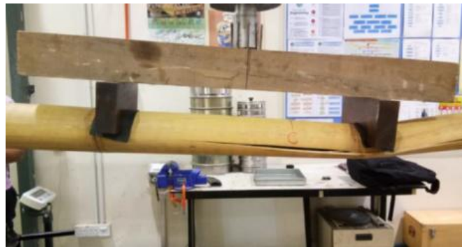
Gambar 31 Local Failure pada bambu oleh Musthaffa et al (2024)
