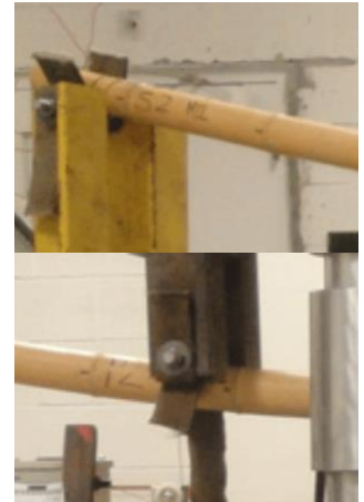
Gambar 3 (a) Konfigurasi Pengujian Lentur, (b) Bentuk Saddle Support, dan (c) Bentuk Saddle Beban oleh Richard et al (2017)
