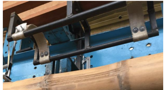
(a) (b) Gambar 4 (a) Konfigurasi Pengujian Lentur dan (b) Bentuk Saddle oleh Trujillo et al (2017)
