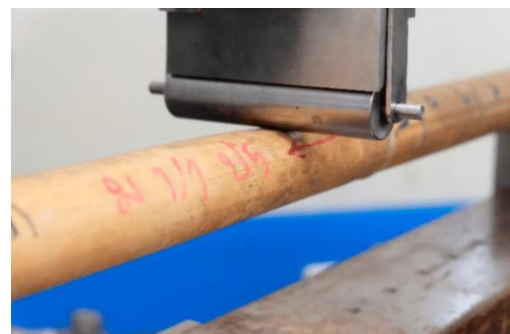
Gambar 9 (a) Konfigurasi Pengujian Lentur, dan (b) Bentuk Saddle oleh Chaowana et al (2021)
