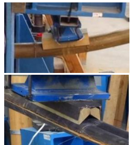
Gambar 7 (a) Konfigurasi Pengujian Lentur, dan (b) Bentuk Saddle oleh Lorenzo et al (2019)
