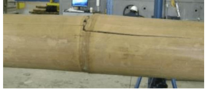
Gambar 30 (a) Compression Failure dan (b) Tension Failure oleh Correal et al (2022)
