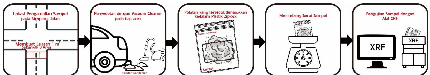
Gambar 2. Proses Pengambilan dan Analisis Sampel Polutan Kendaraan.
