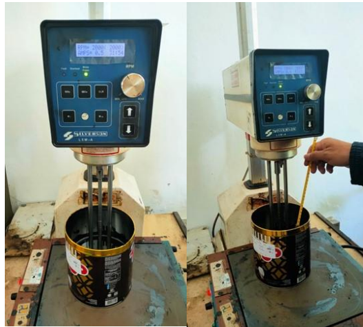
Gambar 1. Alat Mixer Silverson (kiri); Pencampuran Aspal dan PET – Newtlac dengan Menjaga Suhu pada 150°C (kanan).
