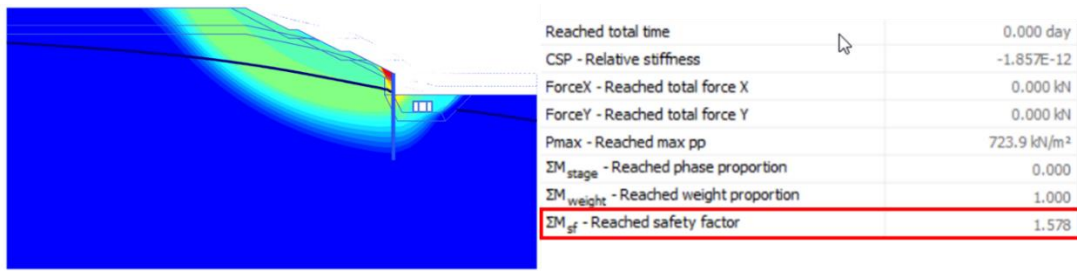
Gambar 6. Safety factor pada tahapan timbunan kembali
